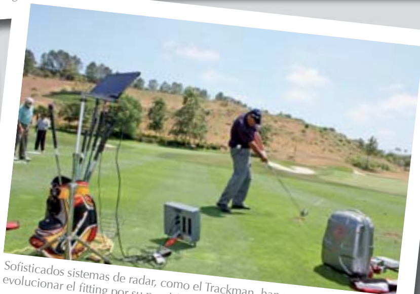
El analizador de swing recoge la información estadística del impacto: velocidad de salida, ángulo de lanzamiento, spin, distancia...
